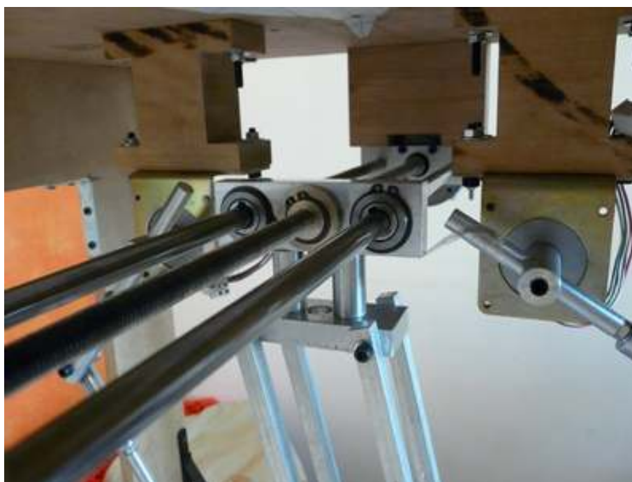
Figura 46 – Guia responsável pelo deslocamento em Y
