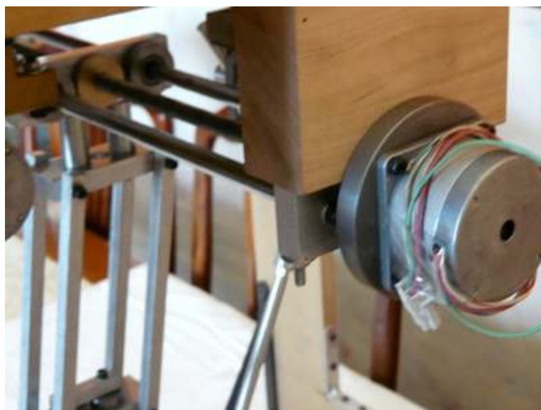
Figura 47 – Motor acoplado a guia
