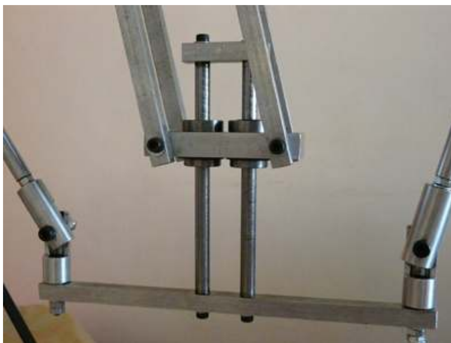
Figura 45 – Guia responsável pelo deslocamento em Z
