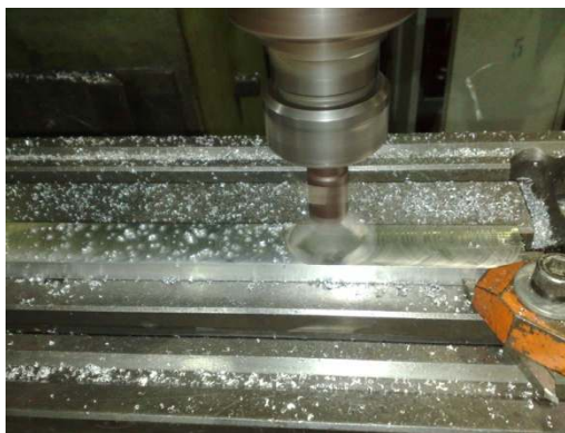
Figura 51 – Usinagem da face superior
